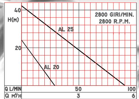
Caratteristiche riferite al funzionamento con acqua - Performances referred to operation with water
